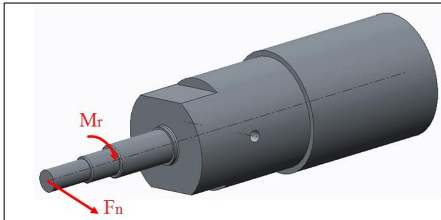
**Fig. 8.** Shaft load
