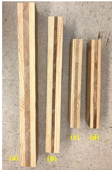
Fig. 1. Bending samples: (a) UD-1.50, (b) DM-0.75, (c) UD-0.75, and (d) DA-0.75
